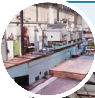
Aus Alt mach Neu: „Upcycling“ – die Aufwertung altgedienter Dinge – funktioniert auch bei Maschinen. Diese Schleifanlage für Arbeitswalzen wurde modernisiert, erhielt eine neue Hydraulik und etwas Farbe und ist jetzt wieder top in Schuss.
