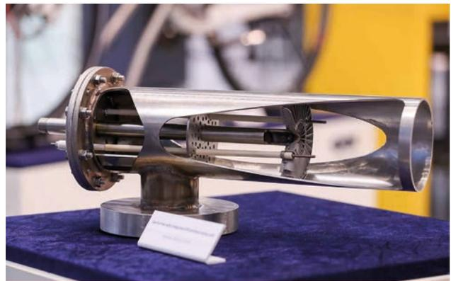
Die neue Brenntechnik kommt aus dem 3-D-Drucker.
