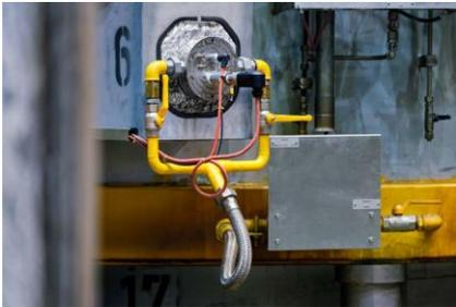
Einfach nur den entsprechenden Hebel umlegen: Die zu Testzwecken umgerüstete Heizhaube im BILSTEIN Werk lässt sich dual sowohl mit Erdgas als auch mit Wasserstoff betreiben.
