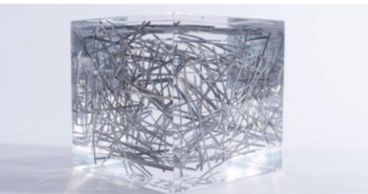
Wie gleichmäßig sich die neue Stahlfaser STABILS im Beton verteilt, zeigt sich anhand dieses Acrylwürfels, den BILSTEIN STEEL FIBER extra für die Messe BAU in München anfertigen ließ.
