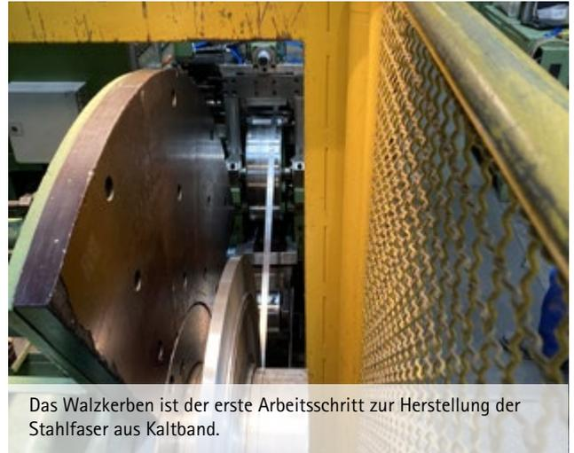
Das Walzkerben ist der erste Arbeitsschritt zur Herstellung der Stahlfaser aus Kaltband.
