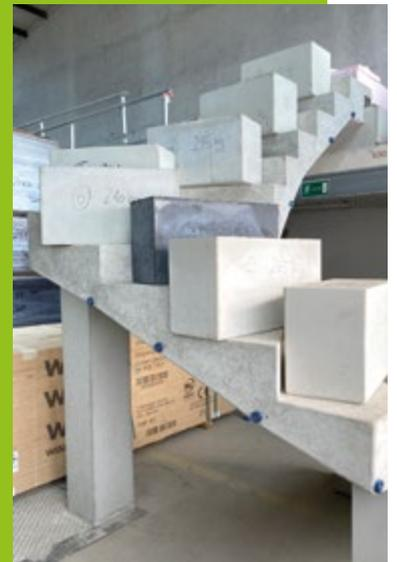
Statischer Belastungstest einer Bontreppe, die mit der STABLS Stahlfaser konstruiert ist.
