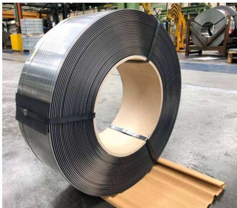
Packengewickeltes Material bietet Kunden erhebliche Produktivitätsvorteile. Im nächsten Jahr gehören gespulte COILS – wie dieses im größten deutschen BILSTEIN-Werk hergestellte – auch zum Portfolio von BILSTEIN COLD ROLLED STEEL in den USA.
